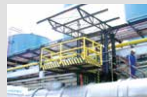
Mástil Elevador para acceder a la boca de inspección de camiones cisterna.
