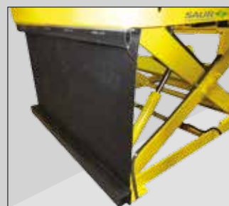
Dispositivos de seguridad en el perímetro externo de la plataforma, que impiden el acceso e interrumpen el movimiento de descenso al encontrar cualquier obstáculo, evitando así el efecto guillotina.
