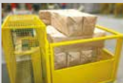
Mástil Elevador Fijo instalado en foso para mejorar la ergonomía del operador durante el montaje de pallets.
