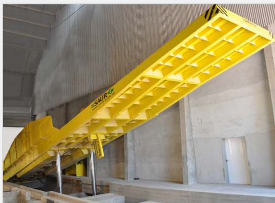
Estructura tipo embutido en el piso, con cilindros internos (bajo la plataforma). Construcción mecánica con perfil tubular.
