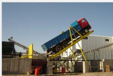
Tapa para tolva cuando se la aplica la descarga de maíz en mazorca, astillas de madera, café, mandioca, frutas, minerales, etc.
