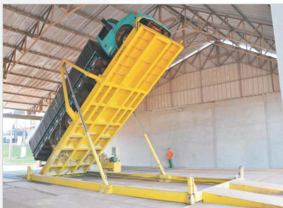
Estructura tipo superpuesta a la tolva, que también se aplica a los modelos móviles.
