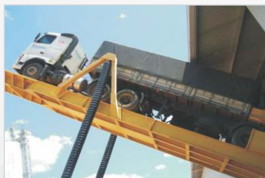
Sistema de protección con cobertura plegable para cilindros.
