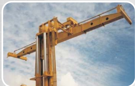
Giro de 4 graus para cada lado do Spreader.
