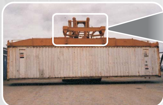
Deslocamento lateral. Nivelamento lateral por correntes.
