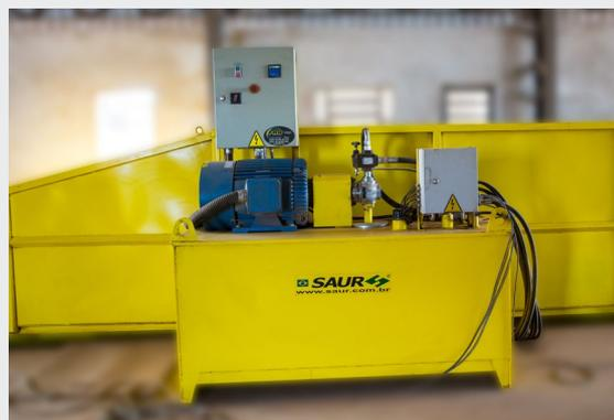
Unidade Hidráulica da Plataforma de Descarga
